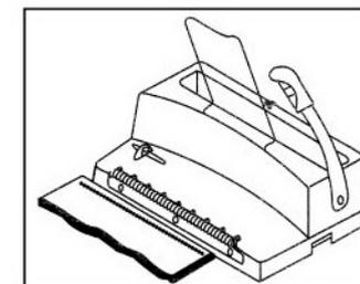
Закрепите металлическую пружину держателем. Вставьте отперфорированный блок в пружину.
