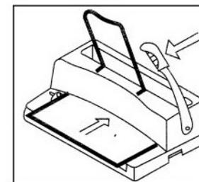
Вставьте переплетаемый блок в окно для перфорации. Зафиксируйте блок. Опустите ручку перфорации.
