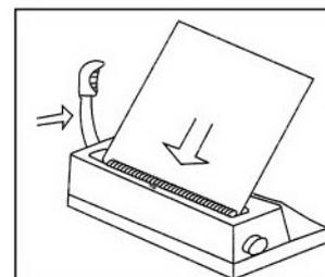
Поместите переплетаемый блок вместе с пружиной в зажимное устройство. Опустите ручку зажима. Переплет закончен.
