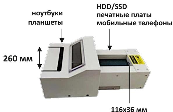
Учитывая форму большинства электронных отходов, для них предусмотрены два загрузочных отверстия.
