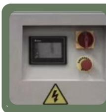
Лаконичная панель управления для безопасного управления. Предусмотрена функция аварийной остановки на случай
