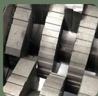
Лезвия из высокопрочной легированной стали предназначены для уничтожения любых видов жестких дисков, включая серверные диски.
